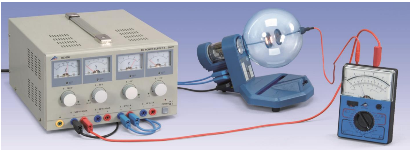
Fig. 1: conexão (acima) para o registro de linhas de reconhecimento de um tubo dódodo e a montagem experimental (abaixo) para o registro das linhas de reconhecimento para diversas tensões catódicas de aquecimento. (1) Cátodo, (2) ânodo
