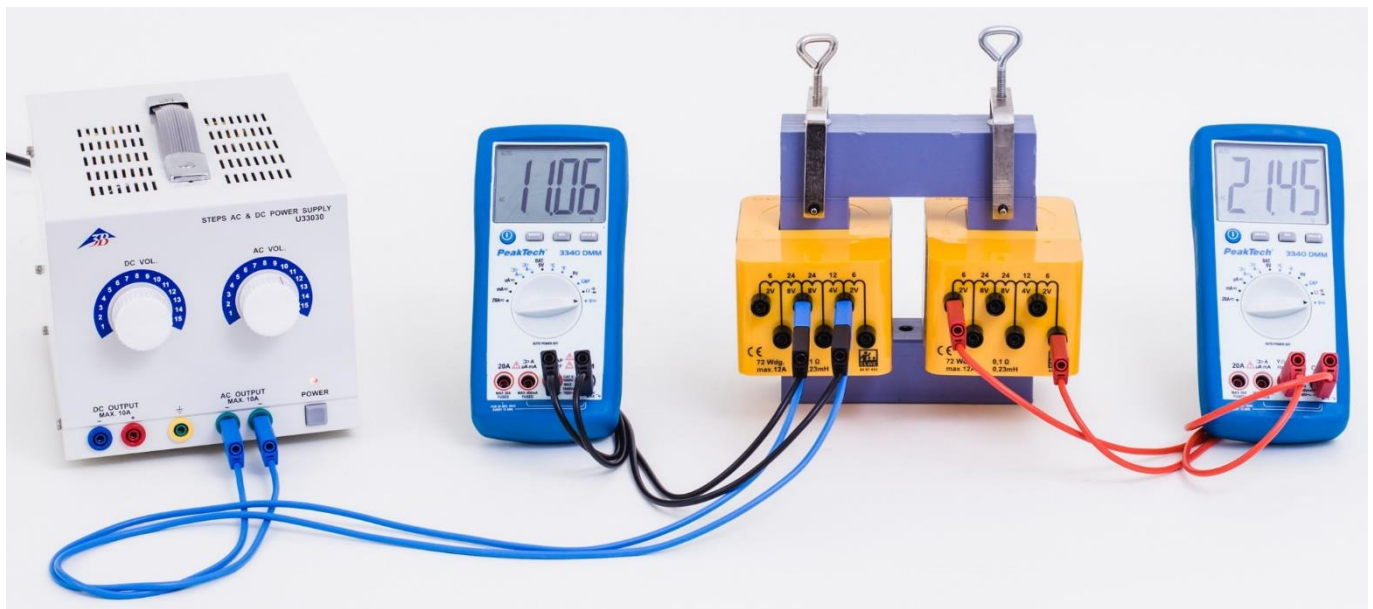
Fig. 1: Disposição para medição da voltagem de marcha em vazio em dependência da tensão primária.
