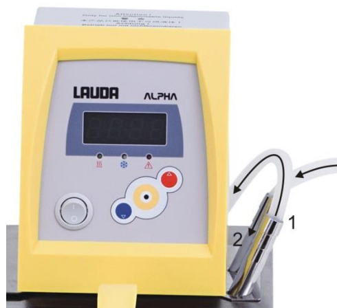
Fig. 10: Avanço (1) e recuo (2) do conjunto de circulação de bombas.
