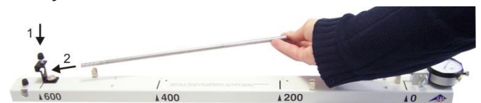
Fig. 6: Fixar o suporte com o parafuso borboleta na marcação 600 do aparelho de expansão de comprimento. Colocar o tubo de teste com a extremidade aberta no suporte.
