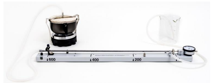
Fig. 12: Montagem com gerador de vapor
