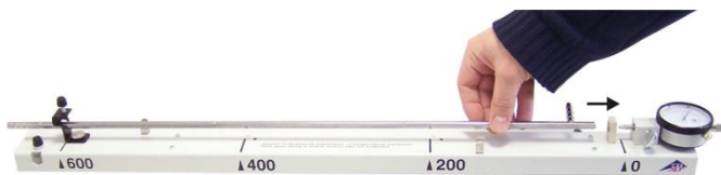
Fig. 7: Colocar o tubo de teste com a extremidade fechada no condutor. Atentar para que o flange aponte para trás.
