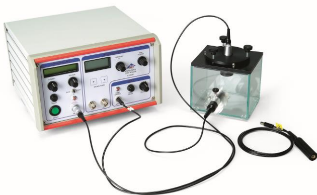
Fig. 3: Arranjo de medição da difração de luz numa grade de fases gerada com ondas de ultra-som num líquido.
