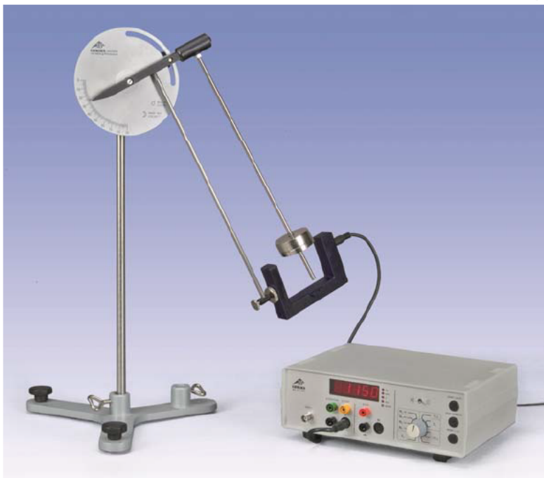
Fig. 1: Pêndulo gravitacional variável (foto e representação esquemática)
