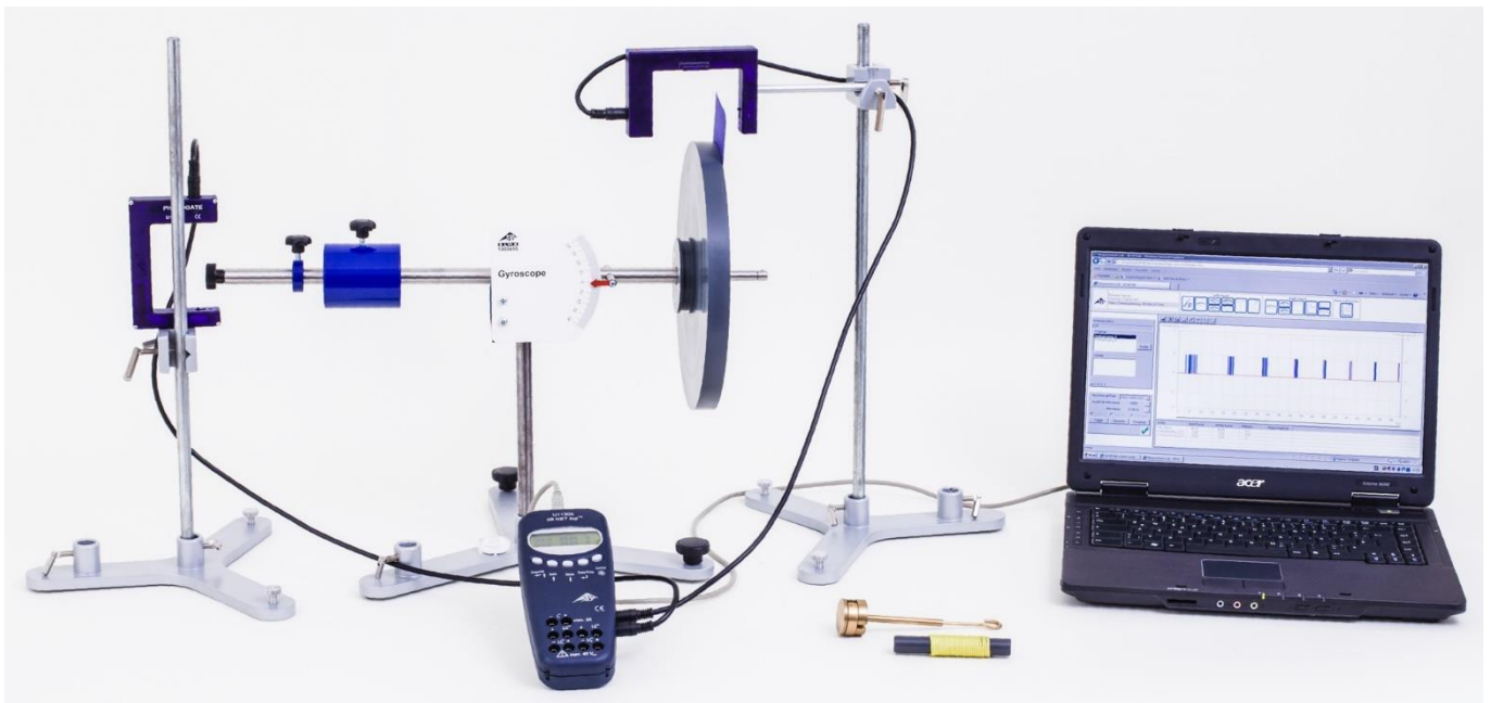
Fig. 1: Disposição de medição para a precessão de um giroscópio (sem massa adicional suspensa).
