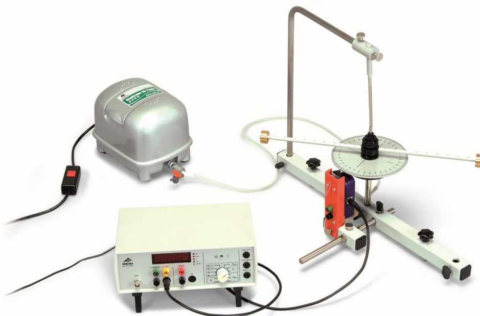
Fig. 1: Arranjo de medição para a determinação do momento de inércia de acordo ao método rotativo-oscilante
