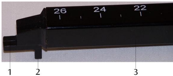
Sonda de campo magnético: 1 Sonda de Hall tangencial (Sentido z), 2 Sonda de Hall axial (Sentido x), 3 Portador
