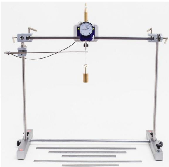
Fig. 2: Montagem da experiência para uma amostra material fixada em uma das extremidades.
