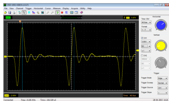
Fig. 2 Pacotes de oscilações em haste de aço inox com comprimento de 400 mm após excitação por impulso
