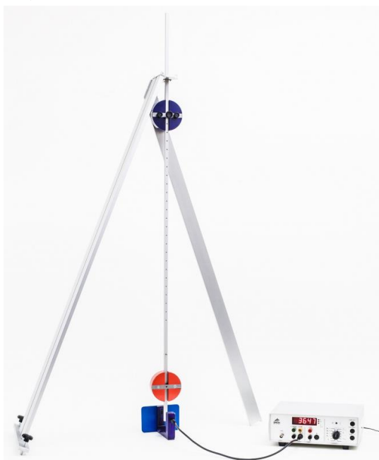
Fig. 5: Montagem da experiência com fotocélula e contador digital
