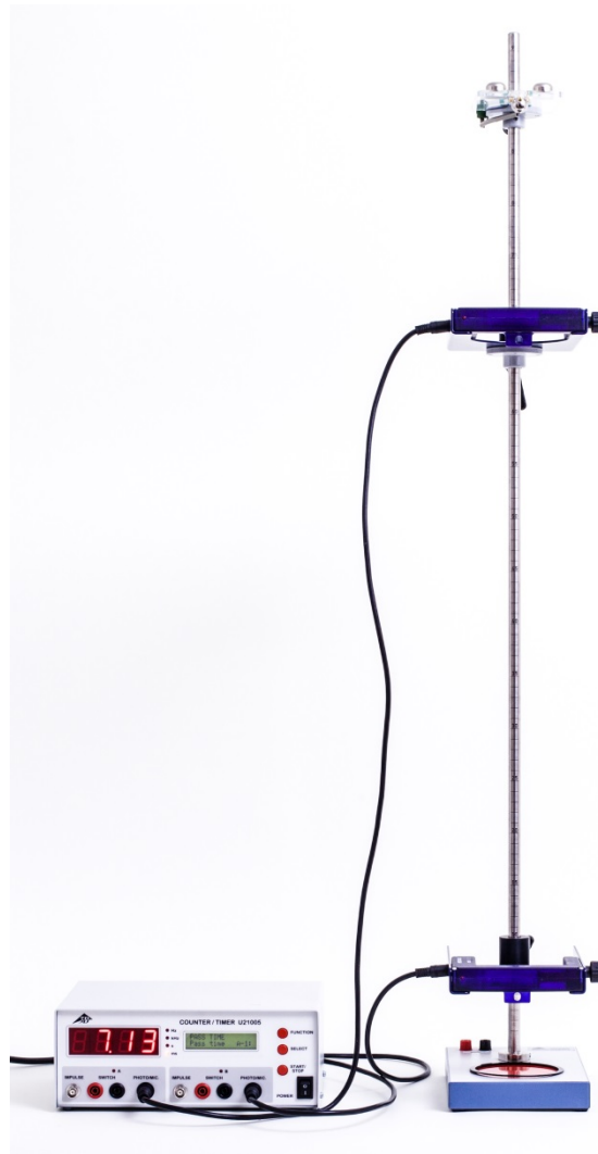
Fig. 1: Montagem da experiência para a medição da velocidade momentânea.
