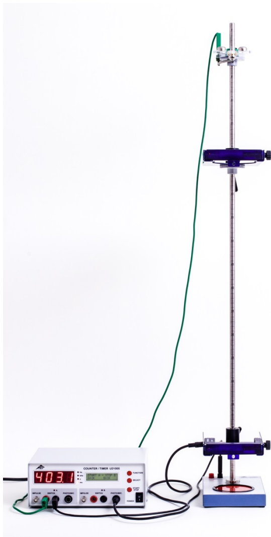
Fig. 2 Montagem da experiência para a medição da velocidade média.
