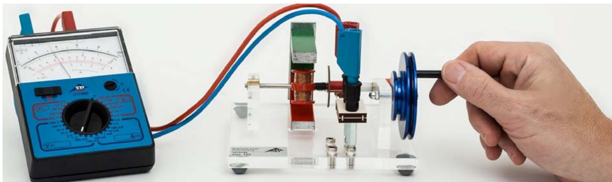
Fig. 3 Operação como gerador de corrente contínua com multímetro ESCOLA 10
