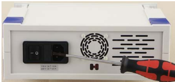
Fig. 1 Troca de fusíveis
