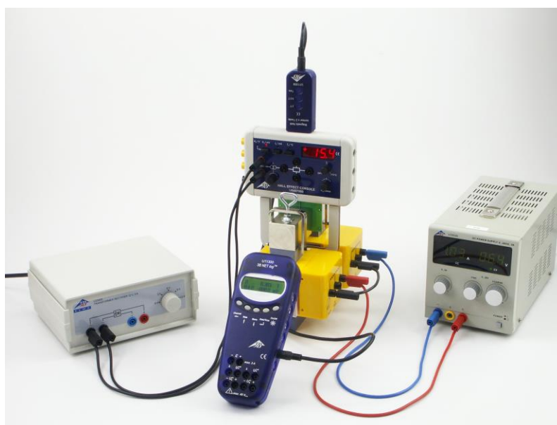
Fig. 9 Montagem de experiência – Efeito de Hall com campo magnético homogêneo
