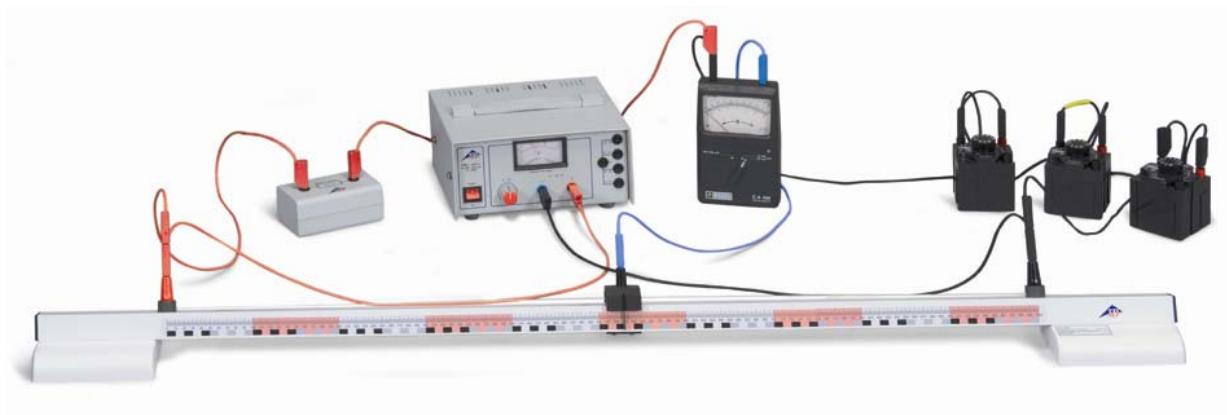
Fig. 2 Determinação de uma resistência numa ponte de Wheatstone
