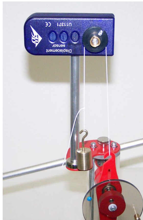
Fig. 5 Fixação do fio no entalho do excêntrico
