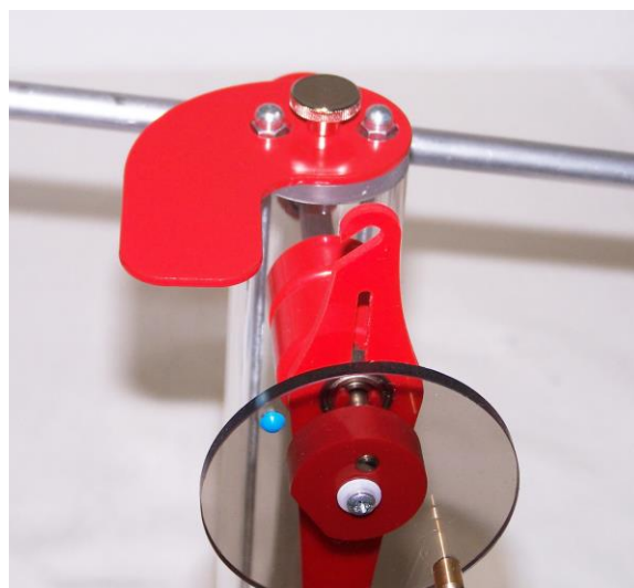
Fig. 1 Montagem da placa de suporte
