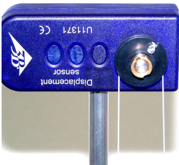
Fig. 3 Condução do fio em volta do rolo
