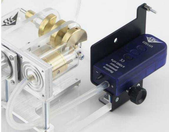
Fig. 2 Montagem do sensor de pressão
