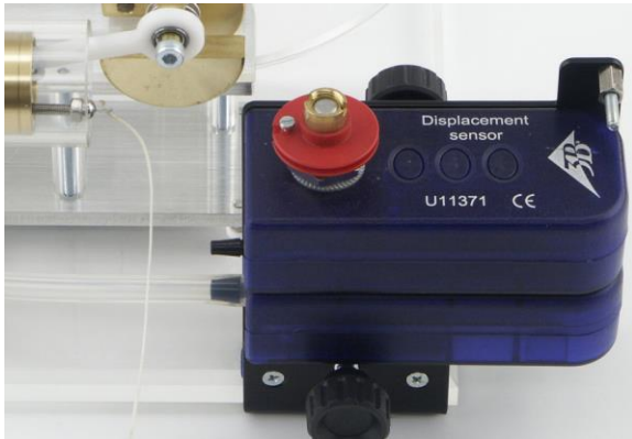
Fig. 3 Fixação da corda no êmbolo de trabalho e montagem do sensor de deslocamento
