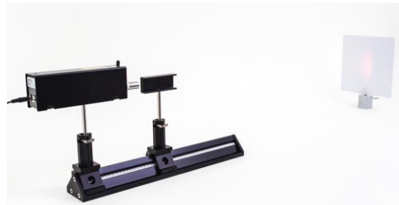
Fig. 3 Montagem do ensaio “Experiência clássica de interferência”
