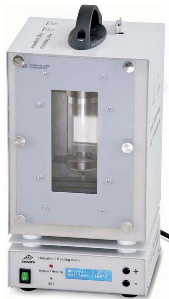
Fig. 1 Parede de forno montada no forno com tubo de fluorescência de sódio
