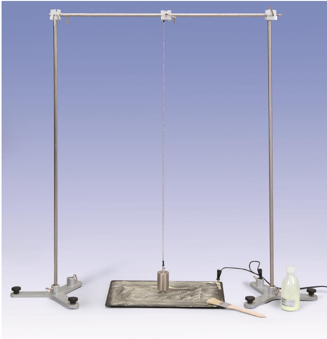
Fig. 2 Montagem da experiência: comprovação da lei de superfície para movimentos de força central (segunda lei de Kepler)
