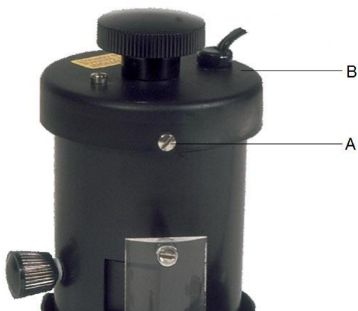
Fig. 1 Troca da lâmpada A Parafusos (3x) B Tampa protetora
