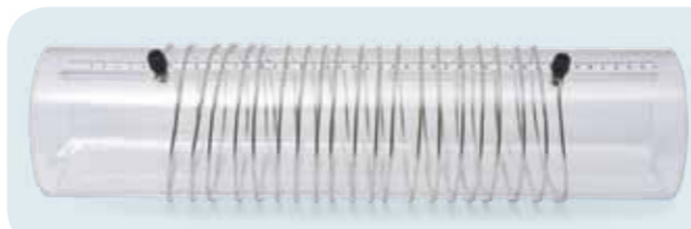
Fig. 1: Bobina com densidade de espiras variável
